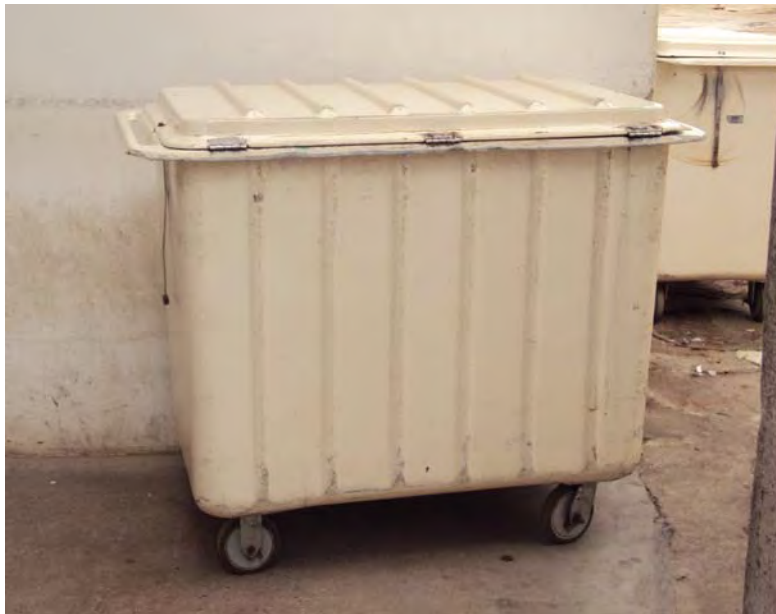
Figura 5: Container para armazenamento temporário e transporte de resíduos infectantes das UTI-Adulto e UTI-PS do HC-FMB
