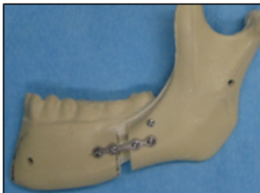
Figura 2 . Osteossíntese com dois parafusos em cada lado da osteotomia utilizando uma mini placa Locking com espaço e parafusos monocorticais Locking de 2.0 x 6 mm, e um parafuso regular de 2.0 x 15mm atingindo ambas corticais 3 mm da distal do segundo molar abaixo da borda alveolar superior.
