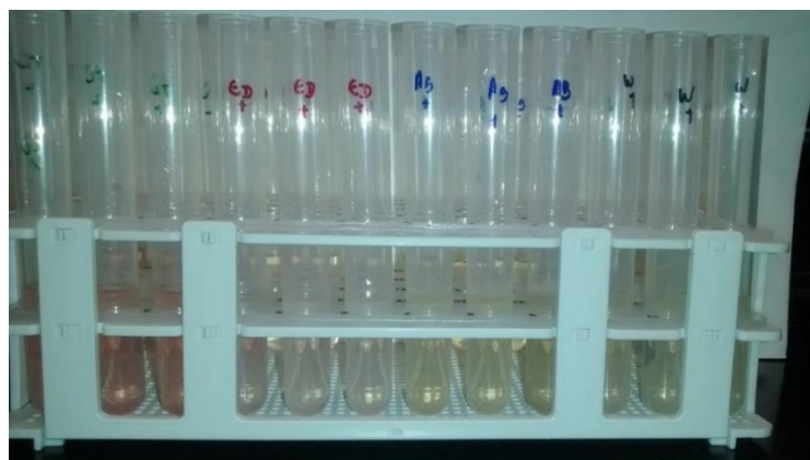
Figura 6.4 - SDA foram preparadas a partir de 2,5 mL de amostra + 2,5 mL solução padrão (Al, Cr, Cu, Mn e Y 2 mg L -1 (grupo 1); Co, Fe, Ni, Zn 5 mg L -1 e Y, 2 mg L -1 (grupo 2)) adicionados a tubos de ensaios do 4200 MIP OES
