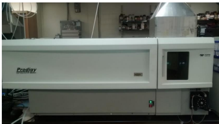
Figura 4.3 - Espectrômetro de emissão óptica com plasma acoplado indutivamente - ICP OES, utilizados para a verificação da precisão analítica de Cr.
