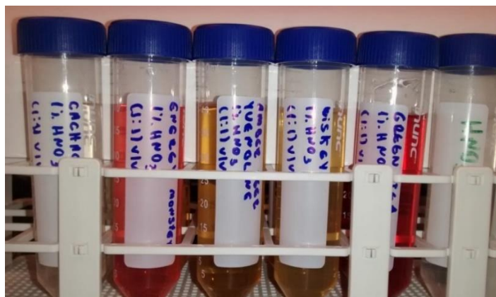
Figura 6.3 - Amostras de café, chá, energético, cerveja (4,4 % v v -1 etanol), whisky (40 % v v -1 etanol) e cachaça (40 % v v -1 etanol), após a diluição 1:1 v v -1 em solução de HNO 3 .
