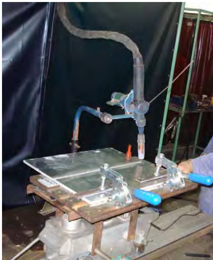
Figura 18 – Equipamento de translação utilizado na soldagem
