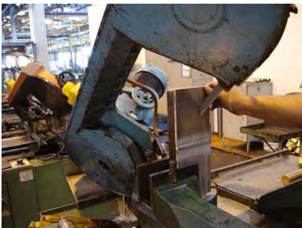
Figura 24 – Corte dos corpos-de-prova para ensaio de tração
