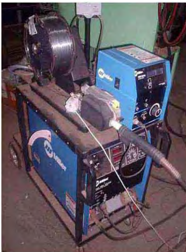
Figura 17 - Fonte de energia multiprocessos, microprocessada
