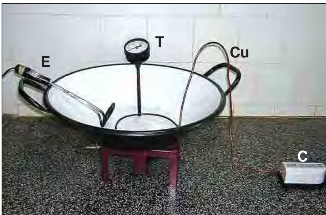
Figura 01: Equipamento utilizado para a oxidação dos óleos. C – compressor de ar; T – termômetro de alta temperatura; E – ebulidor; Cu – cano de cobre.
