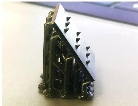
Figura 17 – Molde impresso dos Foguetes de Micro Agulhas de base 800 \mu\text{m} , recém tirado da impressora 3D, curado e limpo com isopropanol em banho de ultrassom por 15 minutos. Fonte: material fotografado pelo autor.
