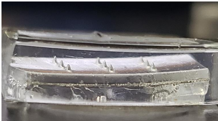
Figura 30 - Molde negativo das micro agulhas 500 \mu\text{m} feito nas condições otimizadas. Fonte: material fotografado pelo autor.
