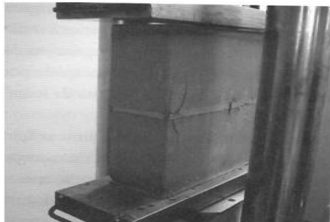
Figura 12 – Ensaio de prisma (2 blocos mais 1 junta)
