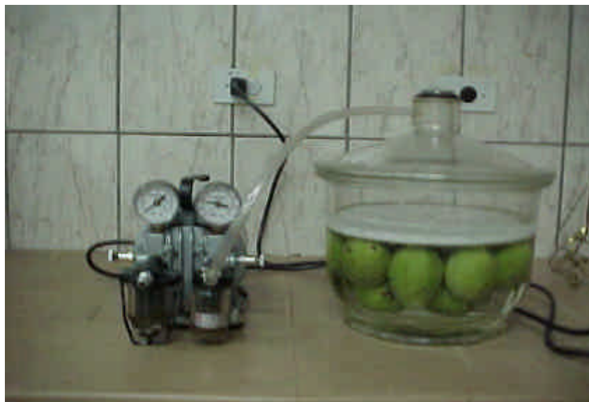
FOTO 1 . Equipamento desenvolvido utilizando-se dessecador acoplado a uma bomba de vácuo, para a infiltração das soluções nas goiabas.
