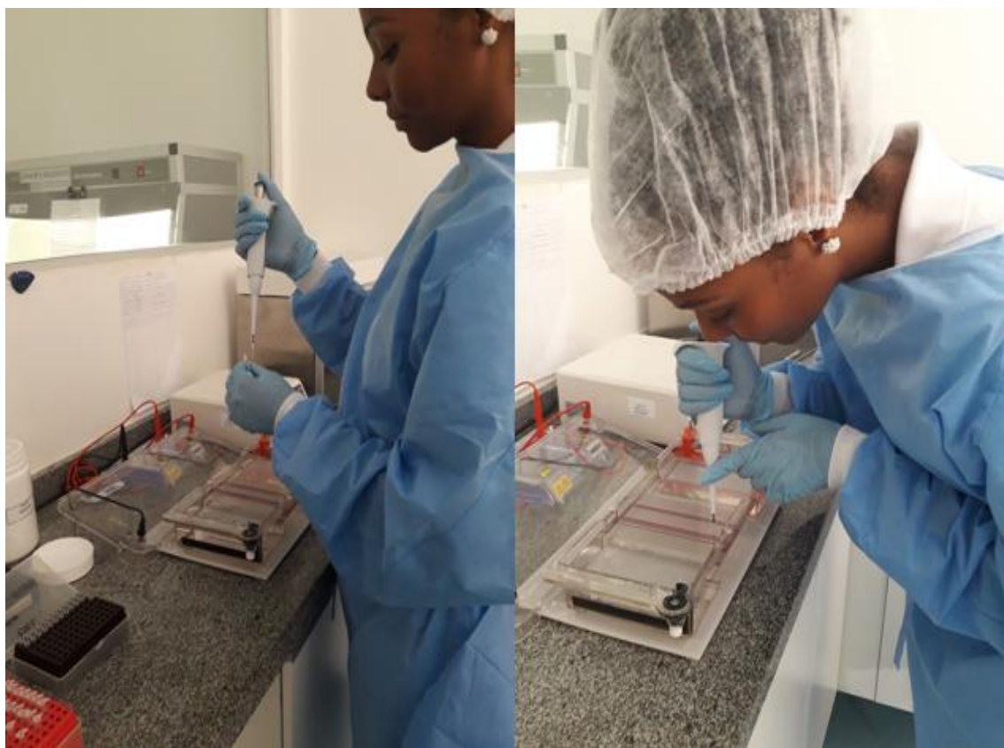
Figura 3: Corrida eletroforética em Gel de agarose 1,5%. Adição do produto da PCR após amplificação. Fonte: arquivo pessoal.
