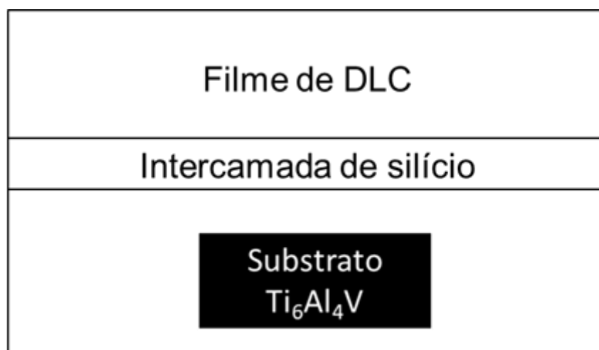
Figura 4 – Representação esquemática da deposição do filme de DLC por PECVD
