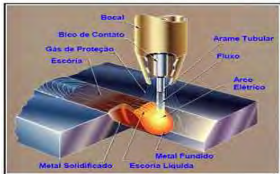
Figura 3.3 – Esquema do processo Arame Tubular com Proteção Gasosa (WELDING HANDBOOK, 1991).
