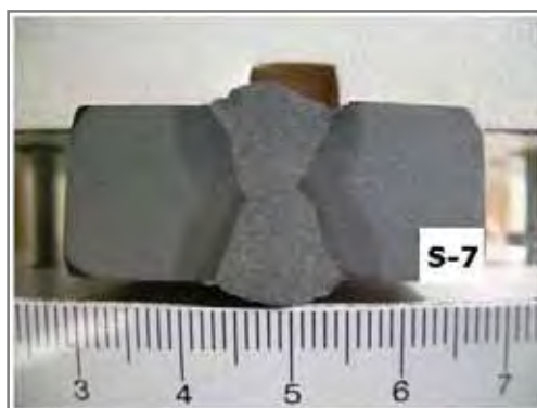
Figura 5.10 – Macrografia da solda S-7.
