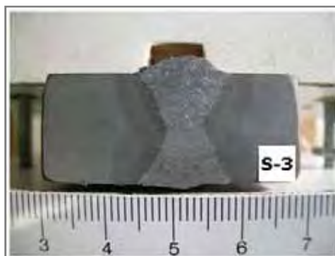
Figura 5.6 – Macrografia da solda S-3. I_p = 435 \text{ A} , t_p = 2,1 \text{ ms} , T = 150 \text{ }^\circ\text{C}
