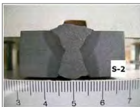
Figura 5.5 – Macrografia da solda S-2.
