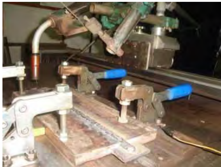
Figura 4.6 - Detalhe da tocha e do equipamento de translação.
