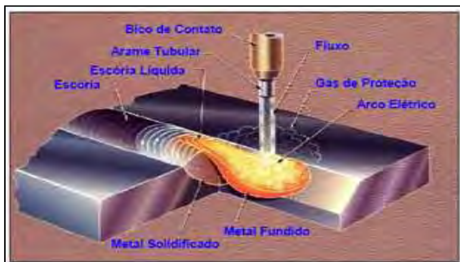
Figura 3.2 – Esquema de Soldagem com Arame Tubular Autoprotégido (WELDING HANDBOOK, 1991).
