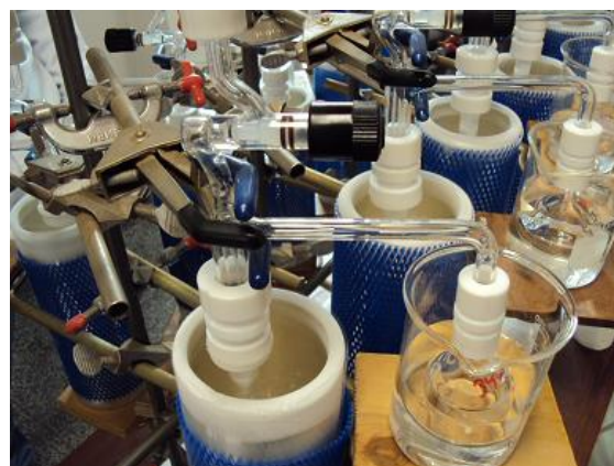
Figura 9. Destilação criogênica a vácuo. O nitrogênio líquido envolvendo o frasco coletor cria uma armadilha criogênica.
