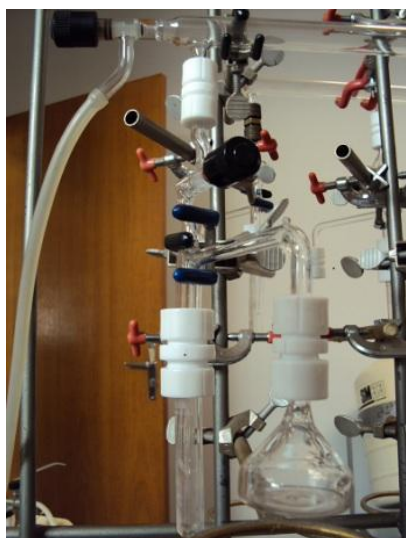
Figura 8. Unidade de destilação. Saída dupla de um bocal da flauta com acopladores de teflon. As unidades possuem válvulas individuais.
