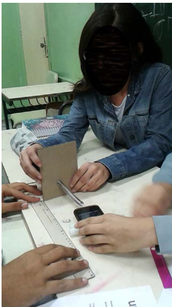
Figura 2 – Alunos determinando a constante elástica da mola.
