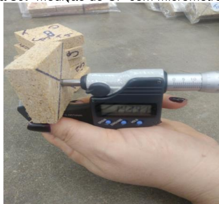
Figura 30: Medição do CP com Micrometro digital
