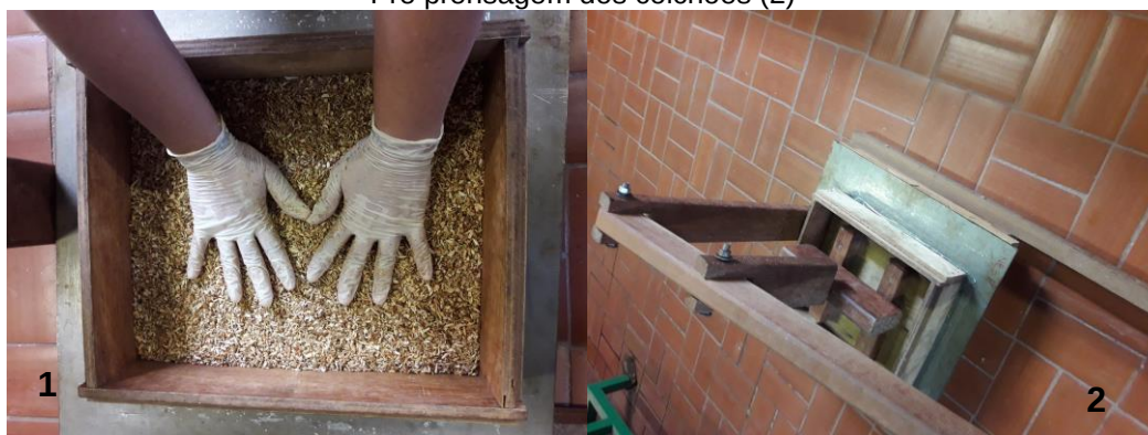
Figura 26: Distribuição manual das partículas de teca e palha de arroz(1) e Pré prensagem dos colchões (2)
