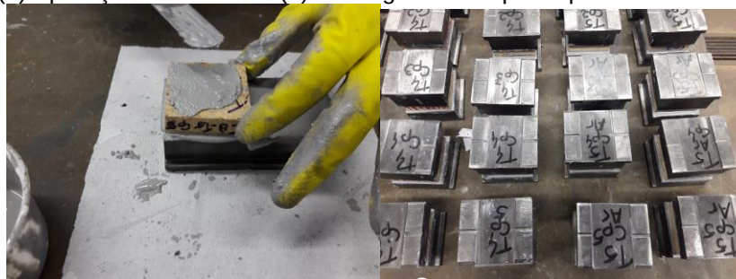
Figura 33: (1) Aplicação do adesivo (2) Montagem do corpo de prova entre os blocos de aço
