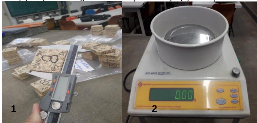
Figura 29: (1) Paquímetro digital de fabricação Mitutoyo (2) Balança eletrônica digital.
