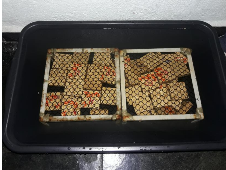
Figura 31: Ensaio do Inchamento em espessura e Absorção após 24 horas
