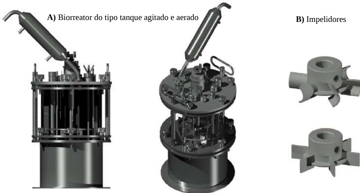
Figura 10. Biorreator do tipo tanque agitado e aerado (A); impelidores tipo turbina de seis pás planas ou tipo Rushton (B).
