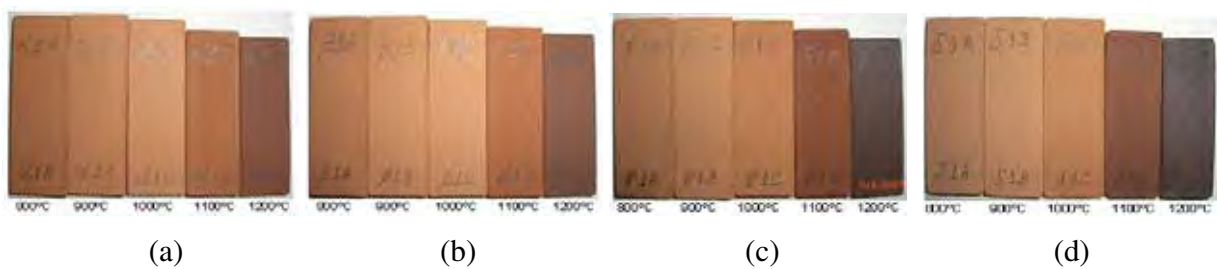
Figura 4.15: Corpos de prova sinterizados: (a) Material Argiloso; (b) Material Argiloso com 20% de Cinza; (c) Material Argiloso com 40% de Cinza; (d) Material Argiloso com 60% de Cinza
