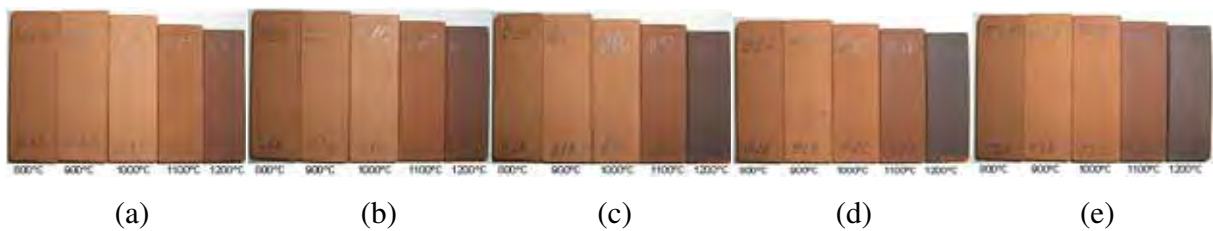
Figura 4.25: Corpos de prova sinterizados: (a) Material Argiloso; (b) Material Argiloso com 20% de rocha; (c) Material Argiloso com 40% de rocha; (d) Material Argiloso com 60% de rocha; (e) Material Argiloso com 80% de rocha
