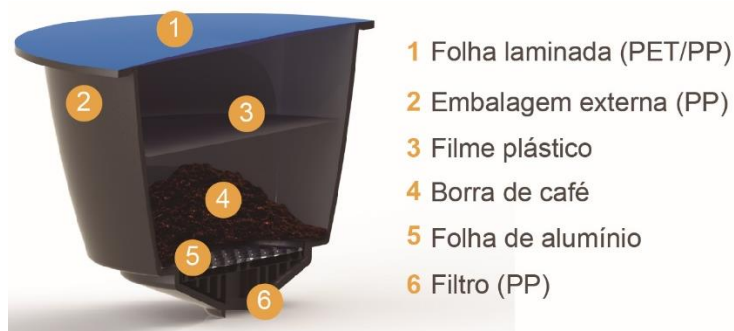
Figura 13 – Modelagem 3D da cápsula Nescafé Dolce Gusto em corte.
