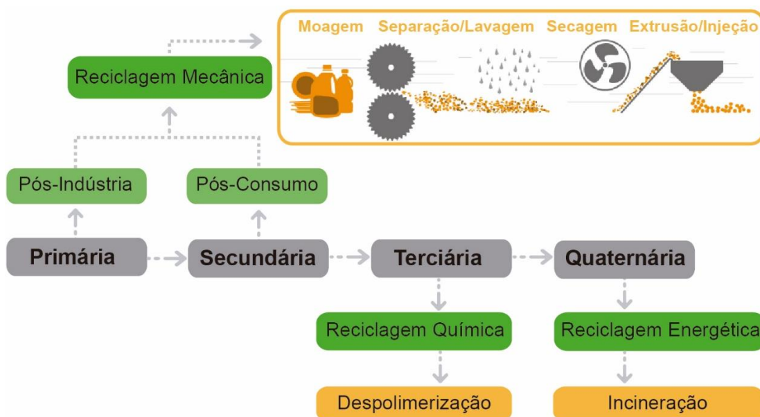
Figura 2 - Métodos de reciclagem de resíduo sólido de plástico.
