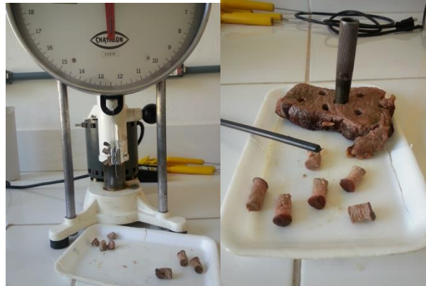
Figura 5: À esquerda encontra-se o aparelho tipo Warner-Bratzler Shear fabricado por G-R Electrical Manufacturing Company , que mede a força de cisalhamento das amostras previamente cozidas, à direita os cortes feitos por ele.
