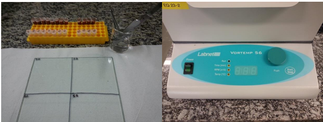
Figura 7: À esquerda, fragmentação da amostra. À direita: Representativo da incubação overnight à 55°C e com agitação de 250 rpm.
