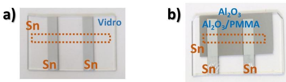
Figura 36 – Foto das amostras utilizadas para monitorar a resistência do Sn durante sua evaporação, sobre (a) vidro e (b) \text{Al}_2\text{O}_3 ou \text{Al}_2\text{O}_3/\text{PMMA} .
