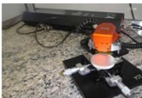
Figura 19 - Aparelho de medidas de AFM NanoSurf EasyScan 2.
