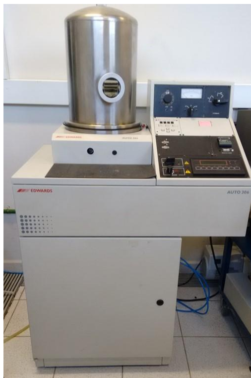
Figura 12 – Foto da evaporadora Edwards Auto 306 FTM6, utilizada para evaporar os eletrodos metálicos.
