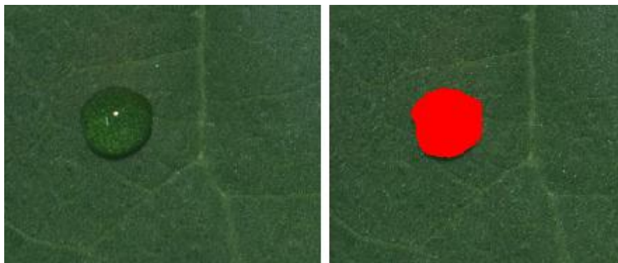
Figura 33 - Gotas recebendo contraste pelo Adobe Photoshop ® para serem analisadas no Quant ® posteriormente.
