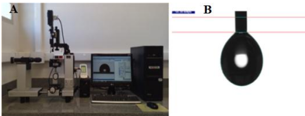
Figura 1. A. Equipamento tensiômetro (Contact Angle System OCA 15-Plus (Dataphysics®) utilizado para medir a tensão superficial das caldas. B. Imagem capturada pelo software da gota pendente.
