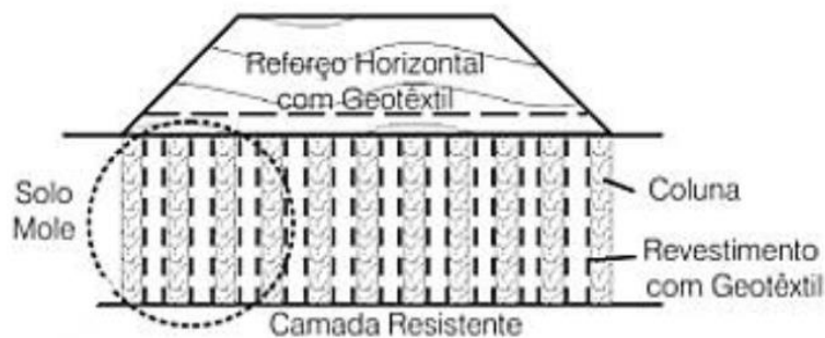
Figura 11 – Reforço de solo com colunas encapsuladas (Araújo, apud Freitas, 2016)
