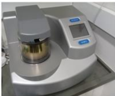
Metalização da amostra com uma camada de ouro com espessura de aproximadamente 5 nm
