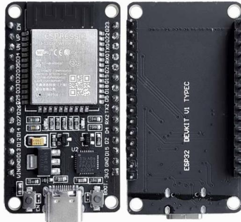
Figura 3: Vistas frontal e traseira do ESP32.
