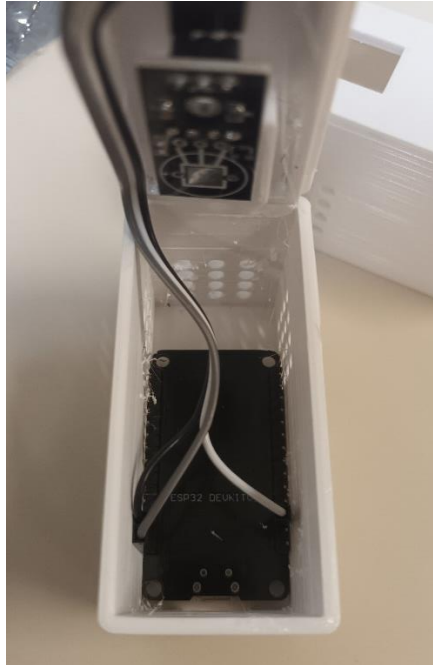
Figura 5: Cabos jumper ligando o sensor DHT22 e o microcontrolador ESP32 dentro da case.
