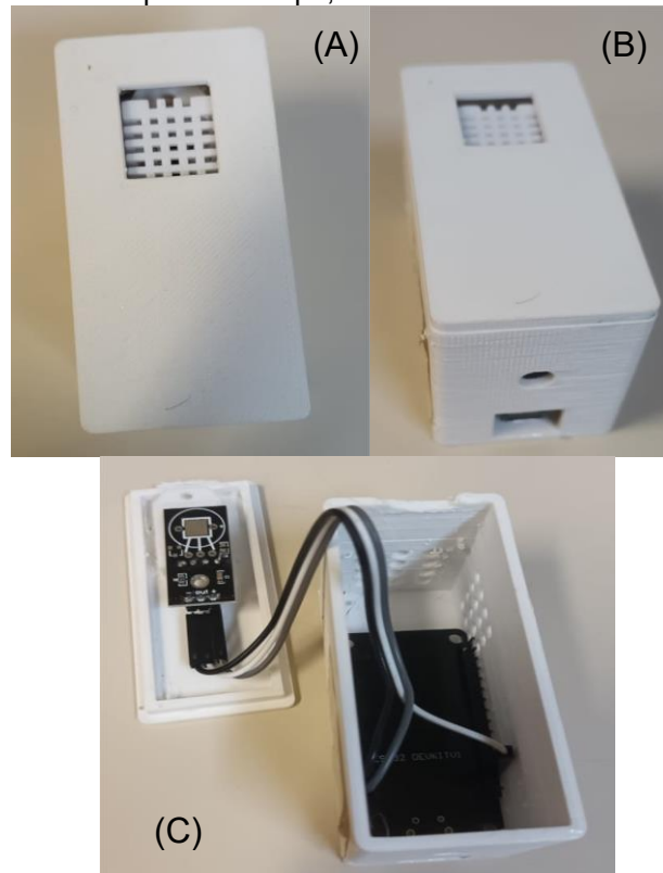
Figura 6. (a) Vista superior do suporte montado, com o sensor DHT22 visível através do recorte retangular da tampa. (b) Vista inferior do suporte, destacando as aberturas para passagem dos cabos e ventilação. (c) Visão interna do suporte aberto, mostrando o microcontrolador ESP32 fixado na base da caixa e o sensor DHT22 acoplado à tampa, com as conexões realizadas por cabos jumper.
