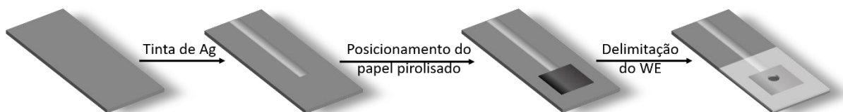
Figura 1. Esquema de desenvolvimento do WE de papel pirolisado.
