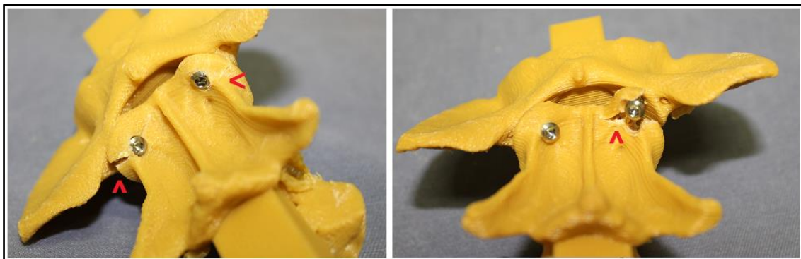
Figura 1A. Imagens fotográficas de corpos de prova do grupo parafusos transarticulares de efeito compressivo (PTA) após a segunda fase dos testes biomecânicos. (>) Nota-se fraturas e fissura da porção cranial do corpo do áxis, no local de implantação dos parafusos.
