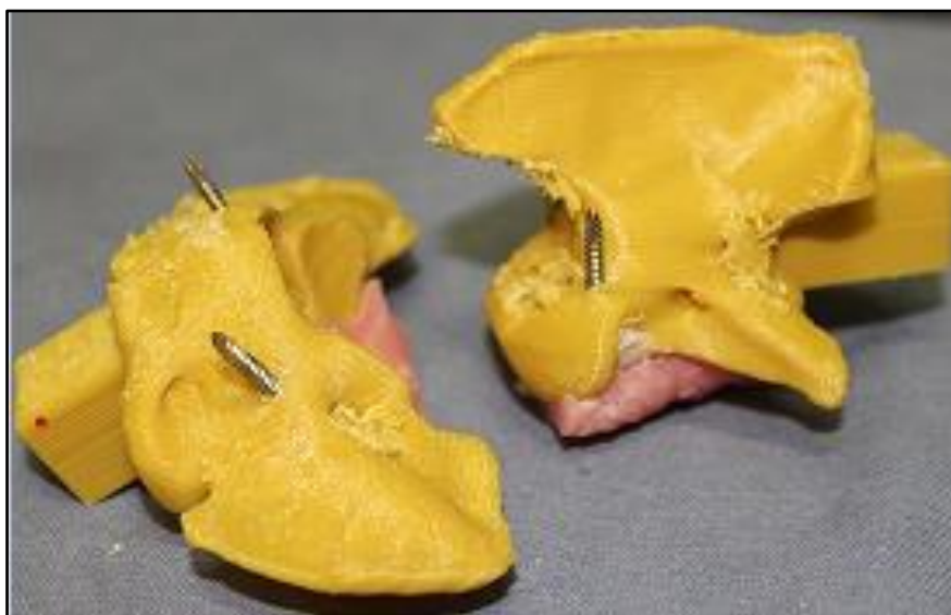
Figura 2A. Imagem fotográfica de corpo de prova do grupo múltiplos parafusos e cimento ósseo (PPMMA) após a segunda fase dos testes biomecânicos. Nota-se fratura do manto de cimento ósseo no espaço articular entre atlas e áxis.
