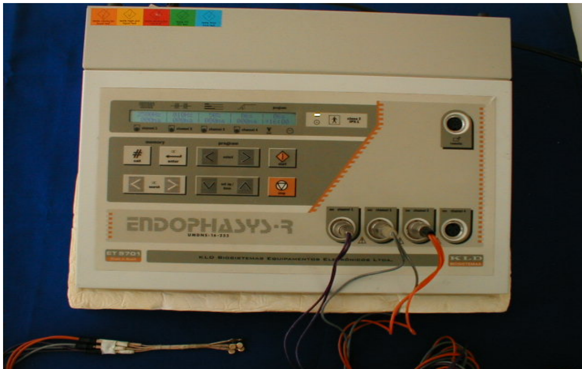
Fig. 2 – Foto do equipamento de estimulação elétrica da média frequência da marca KLD Biosistemas Equipamentos Eletrônicos Ltda. - Modelo Endophasis-R ET 9701, com cabos e eletrodos utilizados para a estimulação dos animais.
