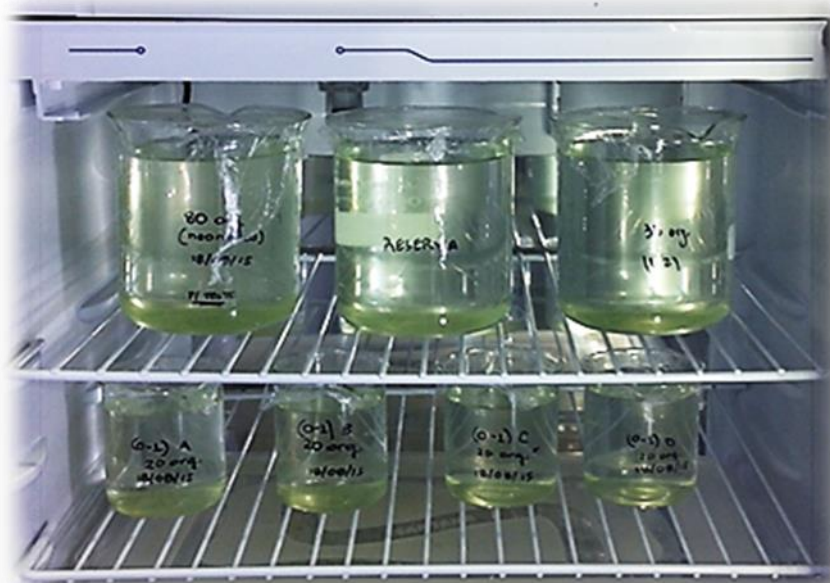
Figura 4. Imagem demonstrando o cultivo da C. dubia mantido em incubadora com controle de temperatura e fotoperíodo.
