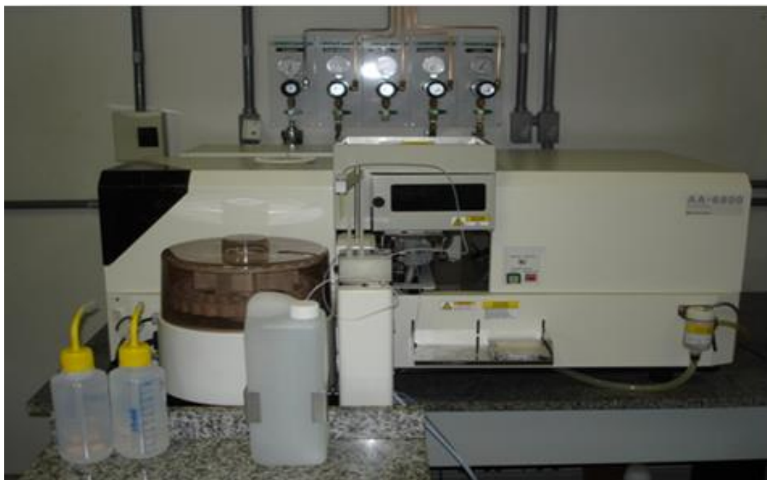
Figura 6. Exemplo de aparelho de Absorção atômica com chama (FAAS) e com atomização eletrotérmica em forno de grafite (GFAAS).
