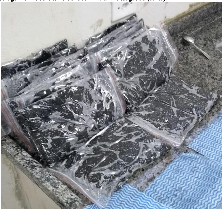
Figura 4. Amostragem em laboratório do lodo in natura desaguado (torta).
