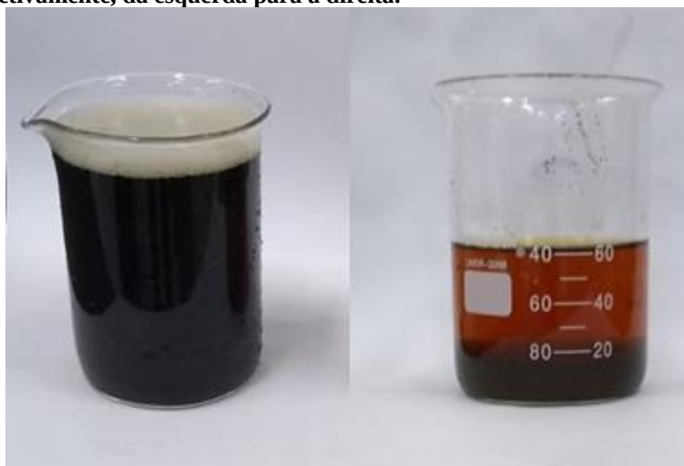
Figura 11. Meio reacional contendo carvão hidrotérmico logo após a CHT, das amostras CH280 – 120 e CH280 – 120A, respectivamente, da esquerda para a direita.
