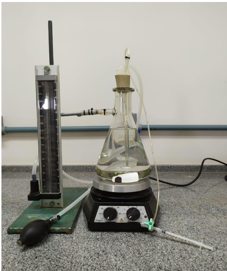
Figura 1 - Aparato desenvolvido para a realização dos experimentos de FLT e taxa de liberação do MZ em diferentes viscosidades, com controle de pressão e temperatura (a temperatura dos meios de dissolução foi mantida através de banho-maria).
