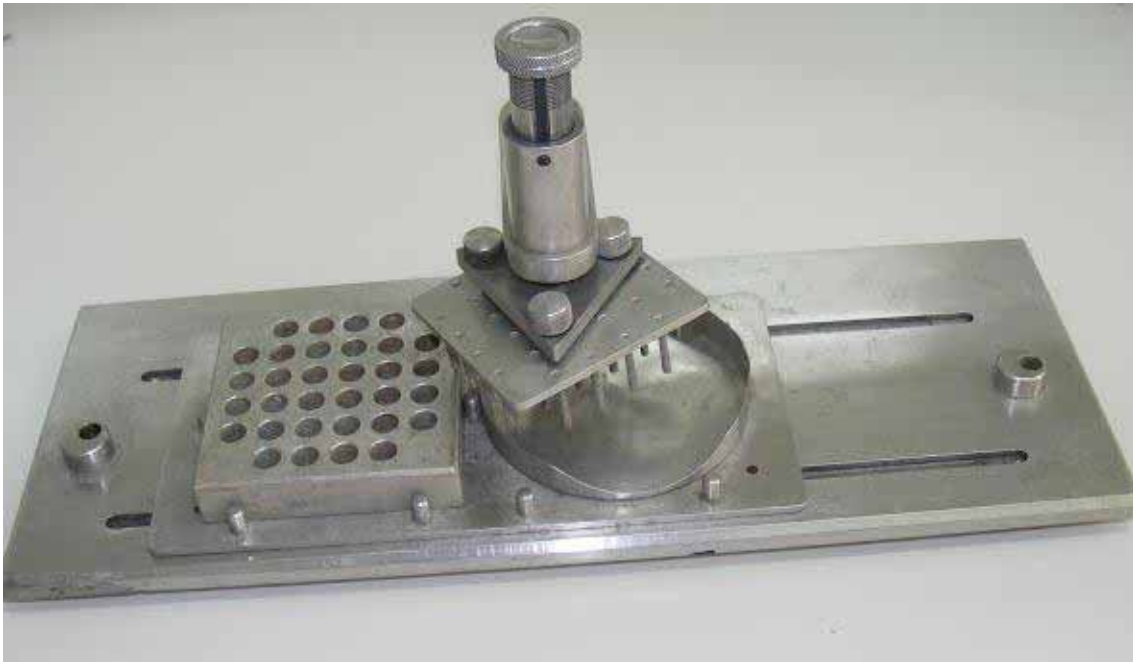
Figura 5. Multiinoculador de Steer utilizado na etapa de determinação das CIM de acordo com a metodologia da diluição em agar. (Fonte: Priscila Martins Leal, 2013).
