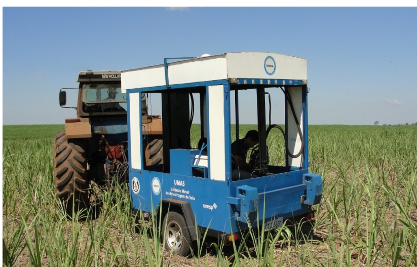
Figura 11. Unidade Móvel de Amostragem de Solo (UMAS) utilizada no experimento.
