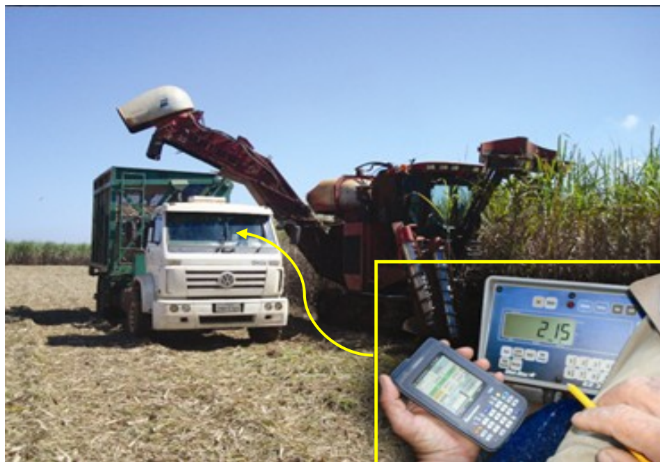
Figura 09. Visor de identificação de pesagem posicionado dentro da cabine do caminhão transbordo instrumentado.
