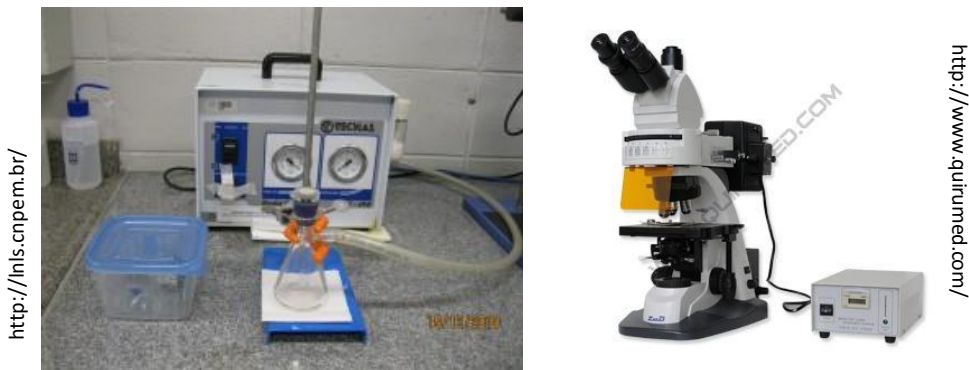
Figura 6-Equipamento de filtração e microscópio de epifluorescência similares aos utilizados no presente estudo
