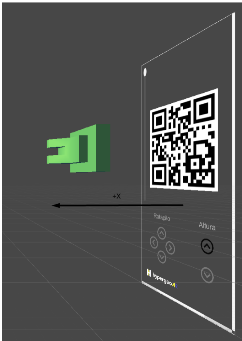
Figura 4.8 - Simulação da translação do objeto 3D no eixo x.
