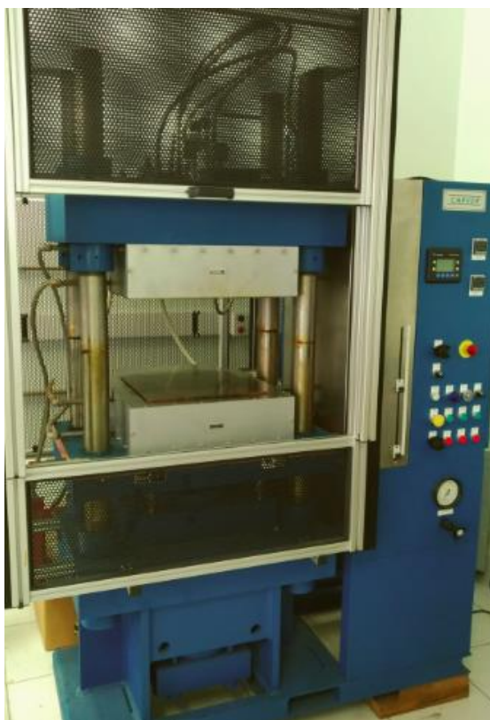
Figura 24: Prensa hidráulica da marca Carver, modelo CMV100H-15-X, série Monarch.
