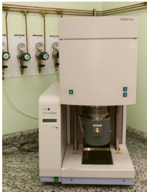
Figura 22: Equipamento de DMA da marca SII Nanotechnology – Seiko, modelo DMS 6100.
