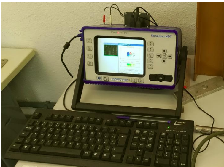
Figura 27: Parte do equipamento de ultrassom da marca Sonotron NDT, modelo ISONIC 2006. Detalhe: Computador onde as imagens são geradas.
