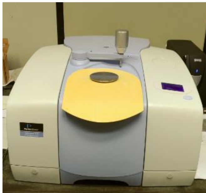
Figura 18: Equipamento de FT-IR com acessório UATR da marca PerkinElmer modelo Spectrum 100 .
