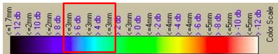
Figura 37: Escala de cores utilizadas na análise de ultrassom com as respectivas medidas de espessura para cada cor.
