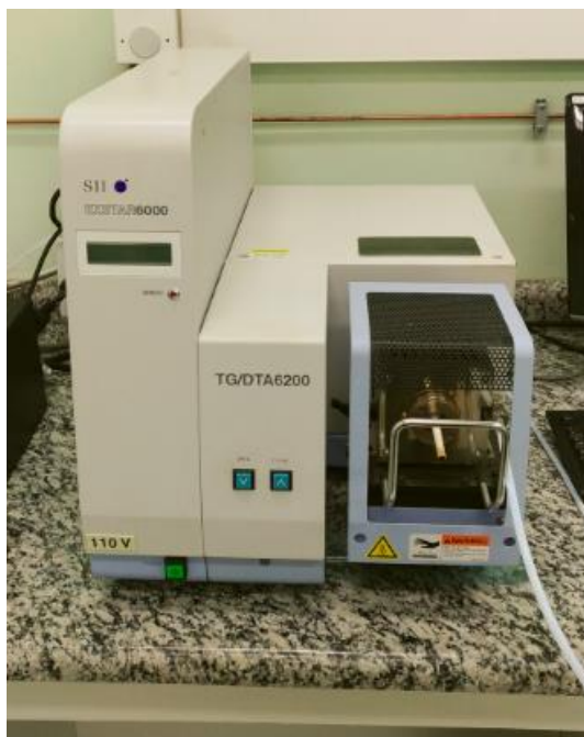
Figura 19: Equipamento de TGA SII Nanotechnology – Seiko, modelo TG/DTA 6200.
