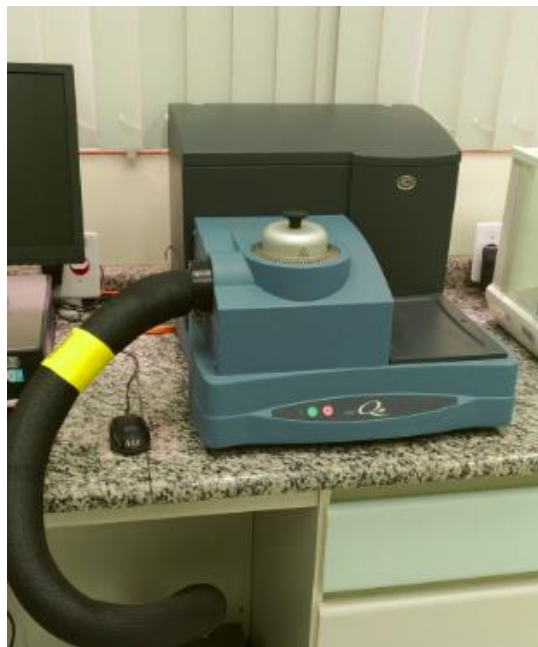
Figura 20: Equipamento de DSC da marca TA Instruments modelo Q20.
