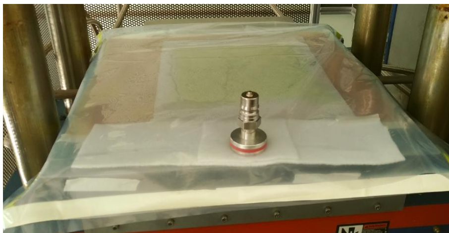
Figura 23: Sistema de bolsa de vácuo montado com bico.
