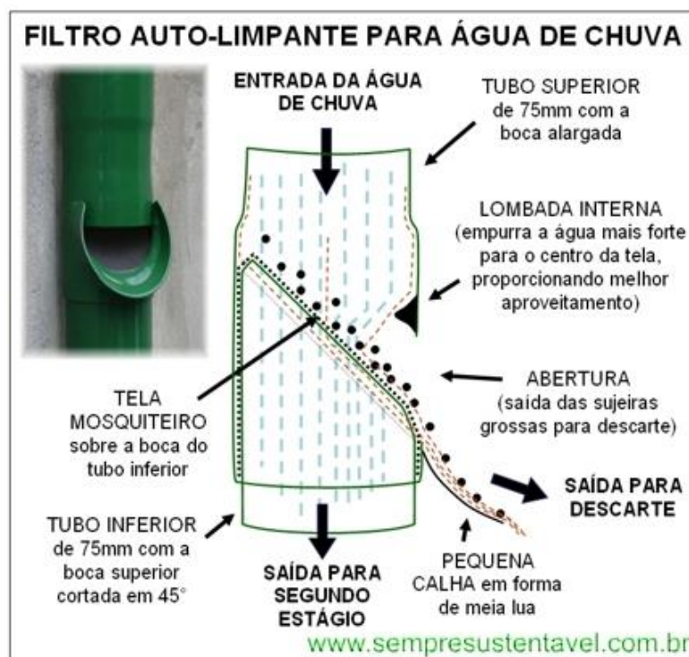
Figura 8 – Detalhes do macro filtro
