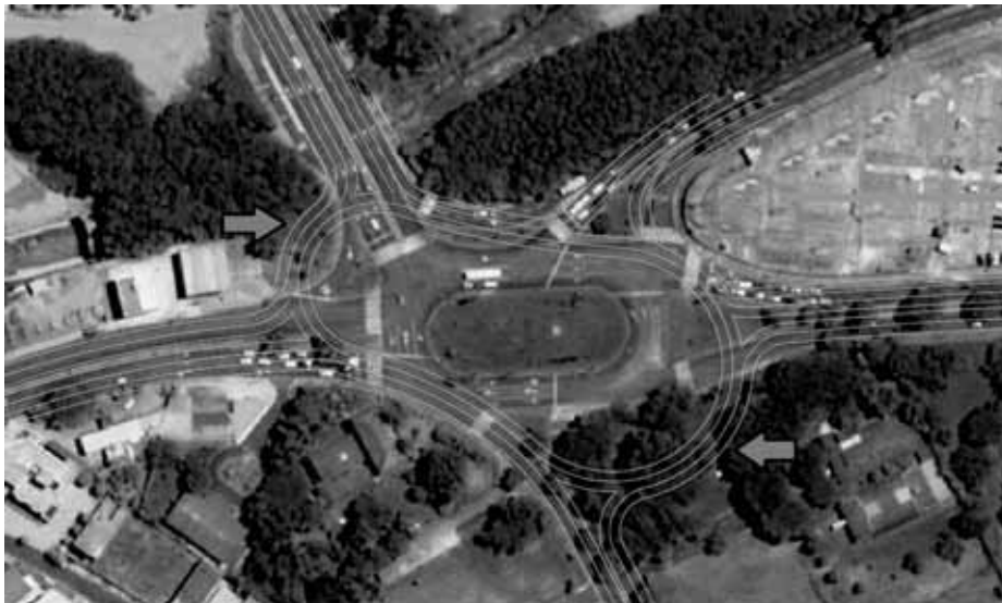
Figura 30: Nova proposta viária com a desapropriação de uma pequena parte do Ambulatório Regional à direita e uma pequena parcela do atual calçamento acima. Fonte: VELÁZQUEZ, F.L.
