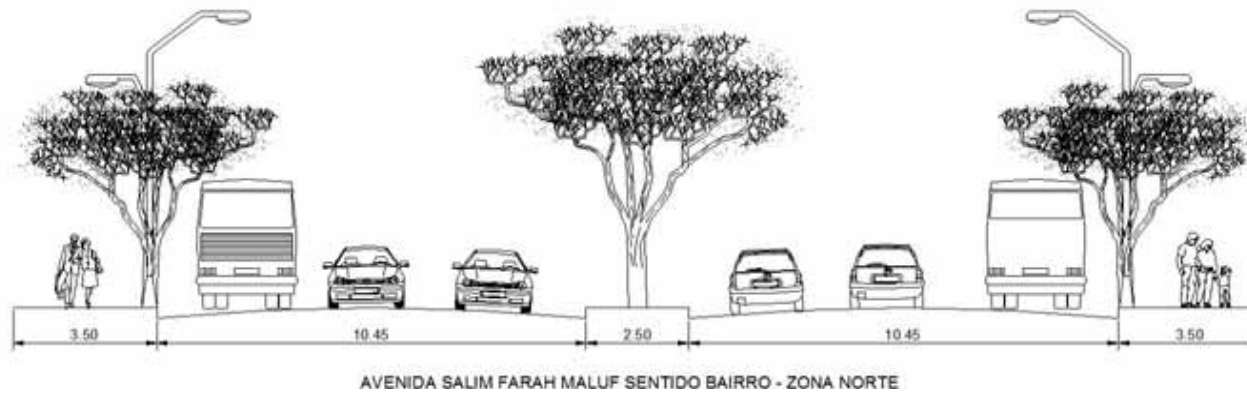
Figura 32: Corte esquemático da Avenida Salim F. Maluf. Fonte: VELÁZQUEZ, F.L.
