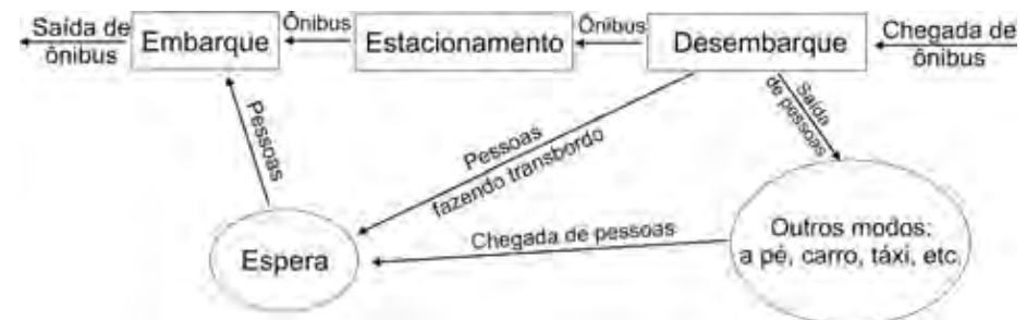
Figura 7: Fluxograma de movimentos e atividades em uma estação de Ônibus urbano. Fonte: FERRAZ & TORRES, 2004.
