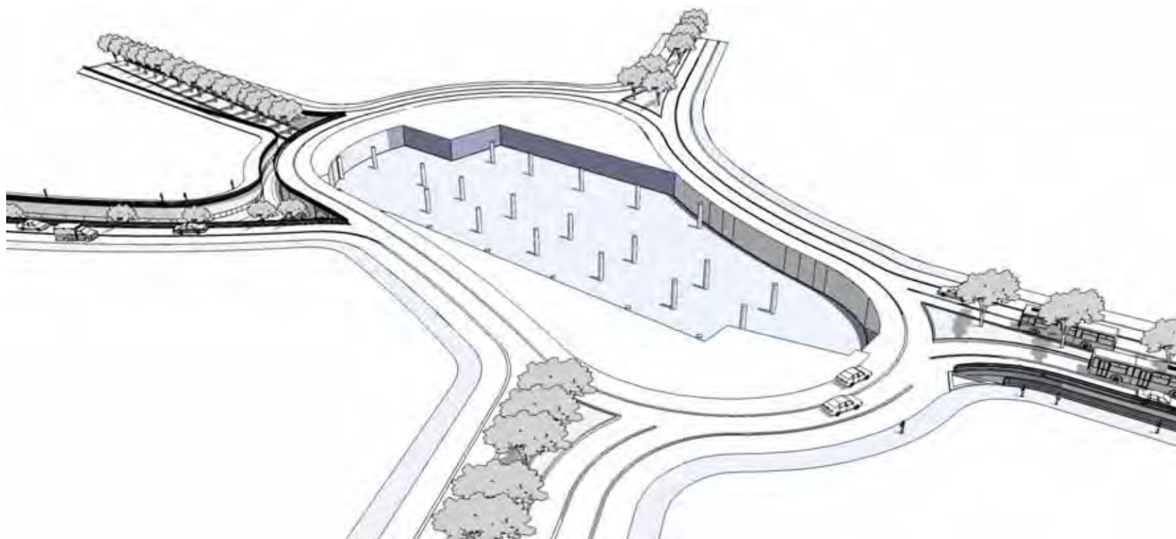
Figura 55: Vista geral da rotatória com a locação dos pilares no subsolo. Fonte: VELÁZQUEZ, F.L.
