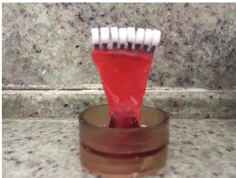
Fig. 6. Fixação dos padrões de cera na base do anel de fundição.
