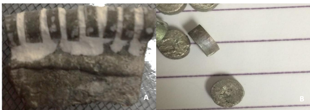
Fig. 9. (A) Desinclusão e retirada dos padrões fundidos. (B) Amostras após recorte e jateamento com óxido de alumínio.
