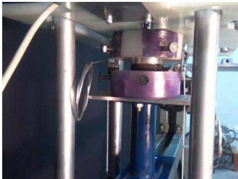
Figura 17 – Fixador inferior solidário ao cavalete e o superior montado na placa móvel
