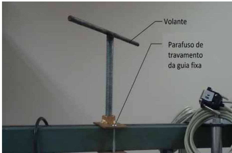
Figura 22 – Regulagem do braço de alavanca para momento de flexão
