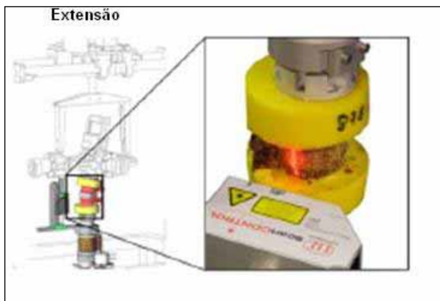
Figura 10 – Utilização de scanner para medir a deformação das fibras do ânulo – Extensão
