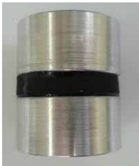
Figura 15 – Corpo de teste - Disco de aço/anel de borracha/disco de aço
