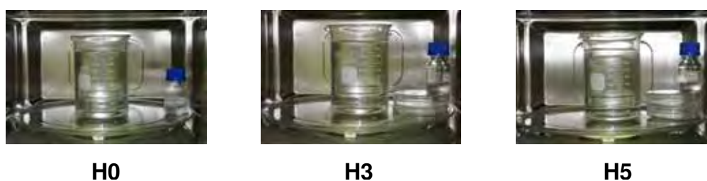
FIGURA 2 - Alturas avaliadas: H0 - ao nível do prato giratório, H3 - a 3 cm do prato giratório, H5 - a 5 cm do prato giratório.
