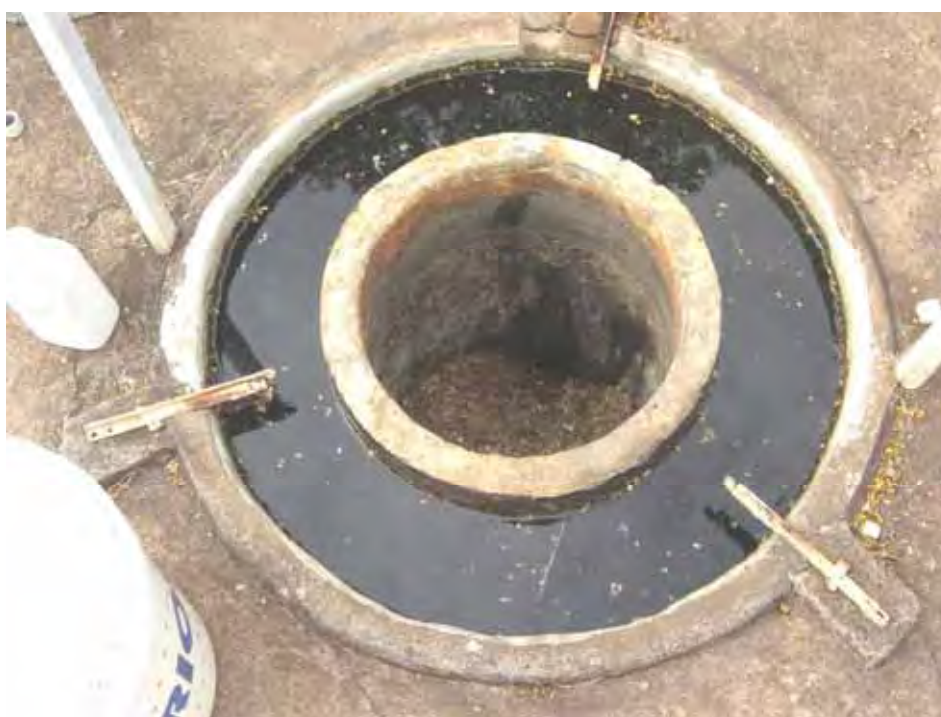
FIGURA 3. Parte interna do biodigestor tipo batelada utilizado no experimento.
