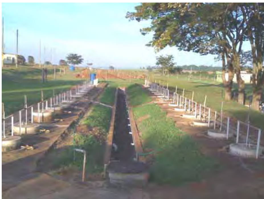
FIGURA 2. Biodigestores tipo batelada utilizados no experimento
