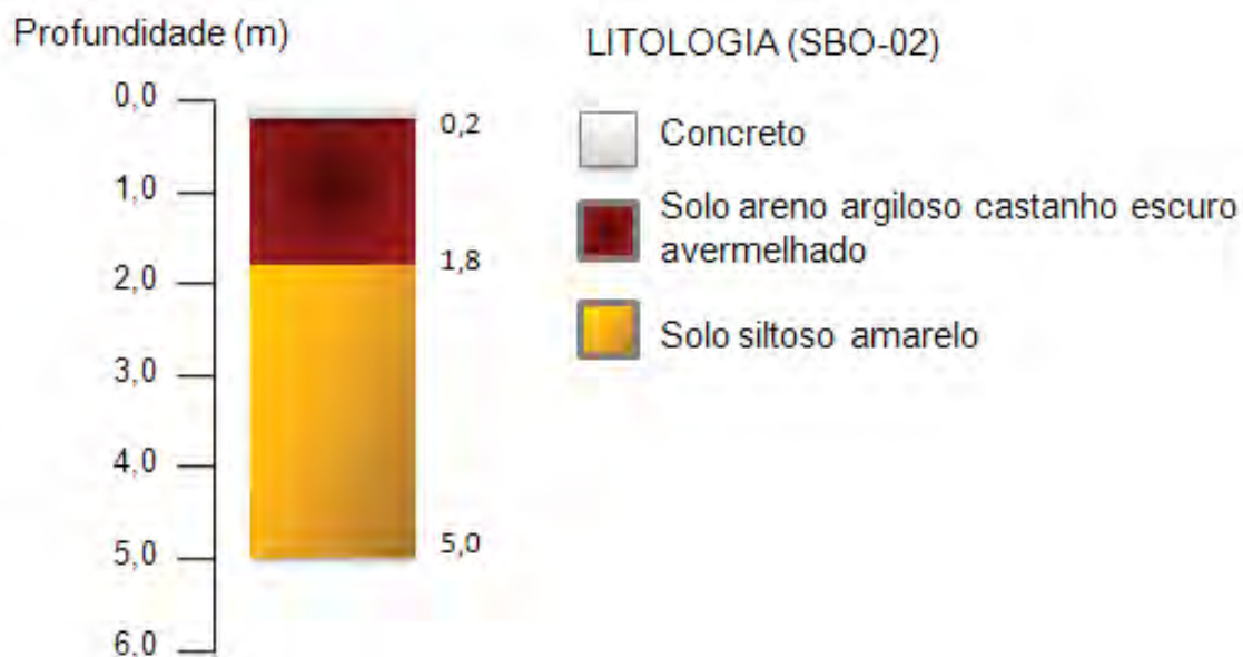
Figura 16: Perfil relativo ao ponto SBO-02 na área de estudo. Fonte: Adaptado de Água Marinha (2005).
