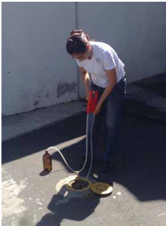
Figura 22: Procedimento de coleta de água subterrânea para análise de ^{222}\text{Rn} .
