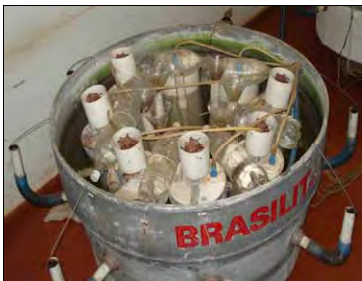
FIGURA 1. Biodigestores acondicionados em caixa de fibrocimento.
