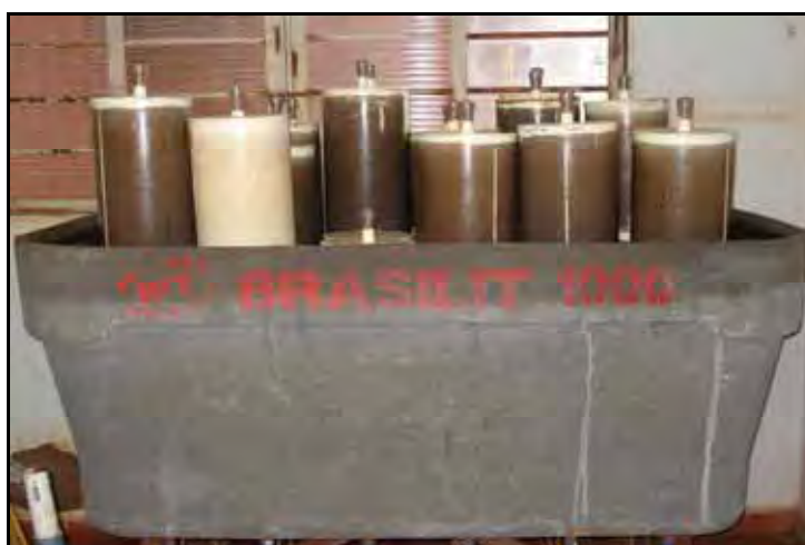
FIGURA 3. Gasômetros independentes acondicionados em caixa de fibrocimento.
