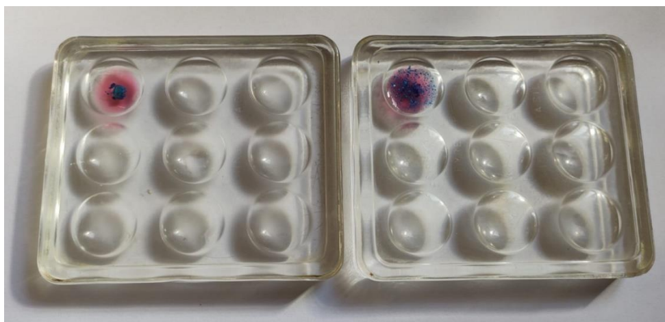
FIGURA 4 – DEMONSTRAÇÃO DE TESTE DE TRIAGEM POSITIVO PARA COCAÍNA, EVIDENCIANDO A COLORAÇÃO AZUL-TURQUESA.
