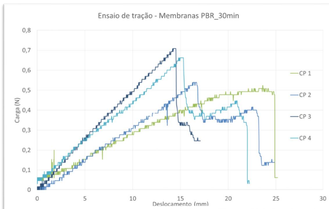
Figura 14. Ensaios de tração realizados em quatro membranas da L-PRF, 30 minutos após a produção.
