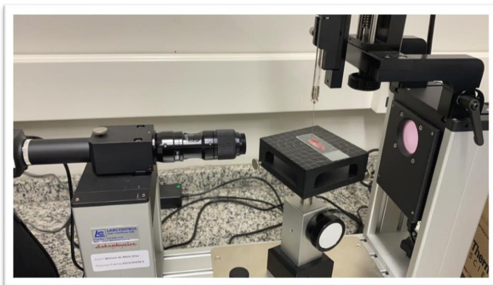
Figura 10. Ensaio de molhabilidade em membrana da L-PRF com instrumento de medição de ângulo de contato óptico, baseado em captação por vídeo câmera de alta resolução.
