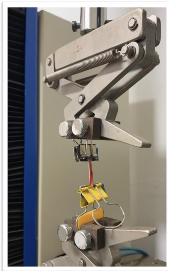
Figura 9. Ensaio de tração da membrana da L-PRF.
