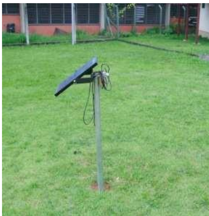
Figura 8 - Painel móvel - dois graus de liberdade
