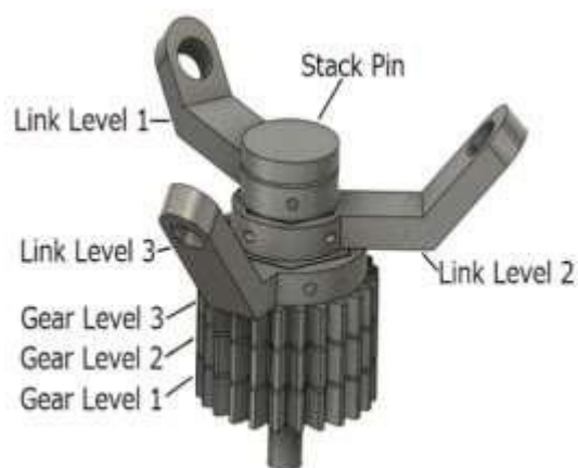
Figura 19 - Componentes - Gear Stack Assembly
