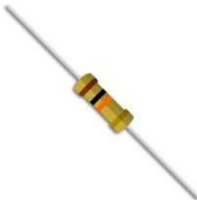
Figura 28 - Componente elétrico - Resistores
