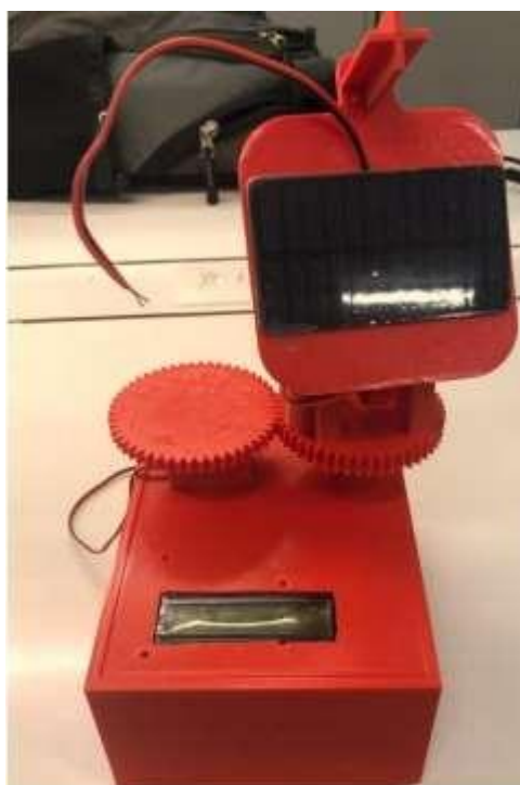
Figura 5 - Protótipo - Seguidor de luminosidade feito através de impressão 3D
