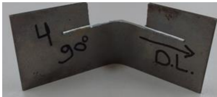
Figura 42: Seccionamento de corpo de prova com dobramento de 90°
