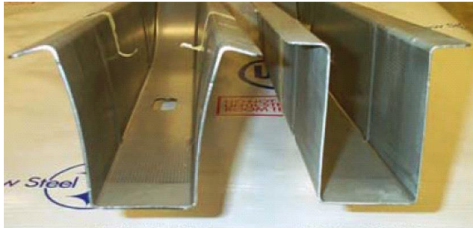
Figura 16: Comparação de retorno elástico entre 2 perfis U produzidos com aço bifásico e HSLA com mesma tensão de escoamento
