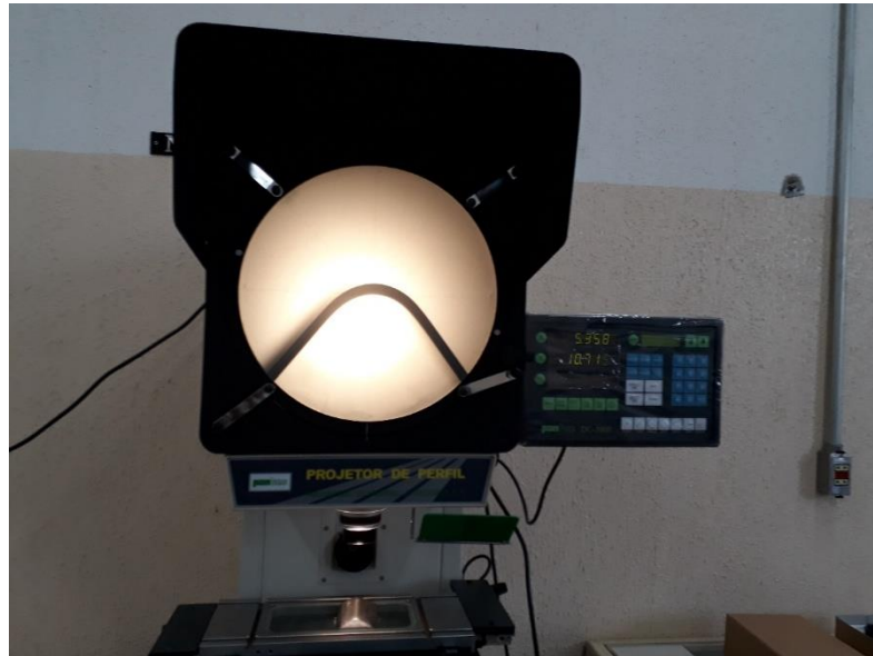
Figura 40: Determinação dos raios de dobramento do aço DP980 para as condições de ensaio com punção de 5 e 0,3 mm
