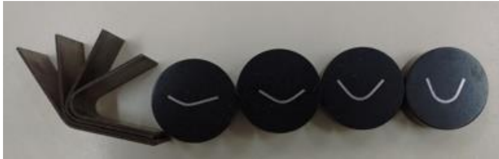
Figura 43: Amostras seccionadas para os ângulos de 120°, 90°, 60° e 30°
