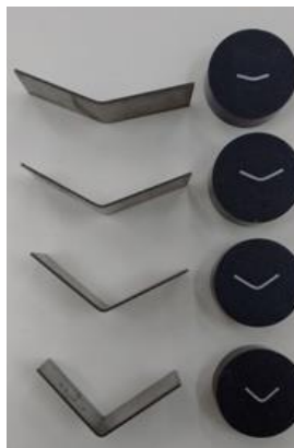
Figura 44: Amostras seccionadas para penetração de cutelo de 5,5 mm, 4,5 mm, 3,5 mm e 2,5 mm
