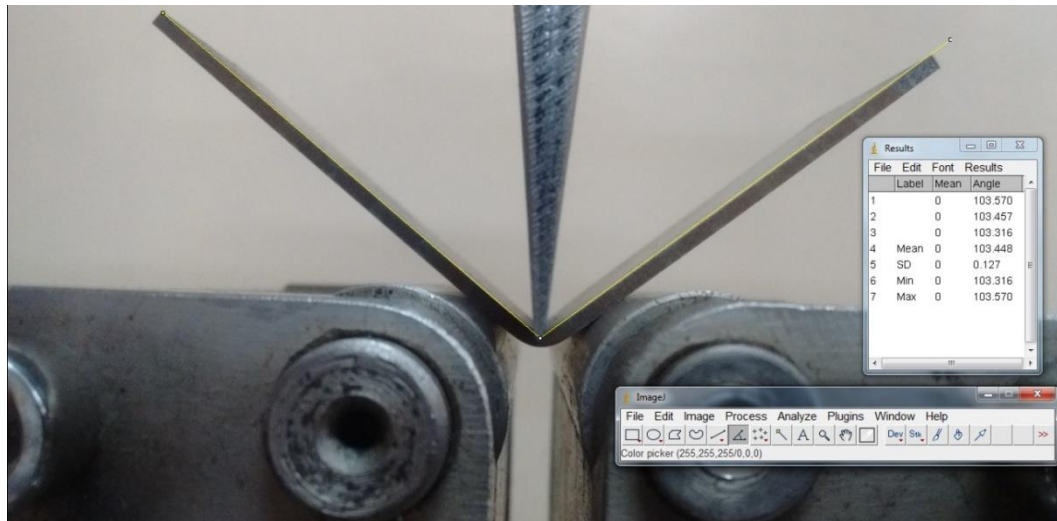
Figura 39: Ângulo interno de dobramento calculado pelo programa ImageJ
