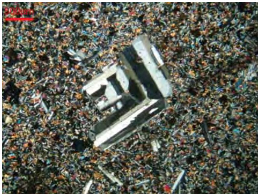
Figura 15 – Microfenocristais de plagioclásio em meio a uma matriz microlítica com cristais de plagioclásio com hábito acicular e augita granular.
