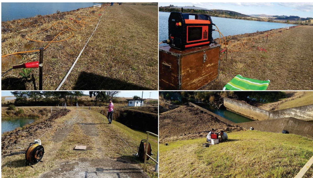
Figura 22 - Detalhe da aquisição geofísica e equipamentos utilizados em campo, dentre eles o resistivímetro, eletrodos, cabos e trenas.
