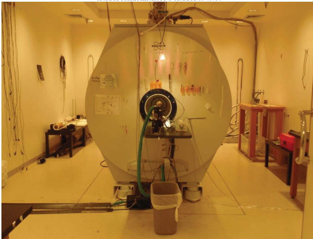
Figura 27 – Espectrômetro 7 T da Bruker (BioSpec 70/30 USR, Bruker, Karlsruhe, Alemanha) utilizado para os estudos relaxométricos e estudos in vivo .
